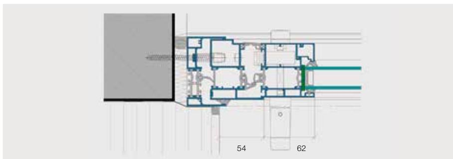
Horizontalschnitt mit Bedienungsflügel, einwärts öffnend
