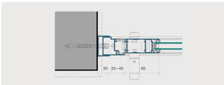
Horizontalschnitt mit Bedienungsflügel, einwärts öffnend
